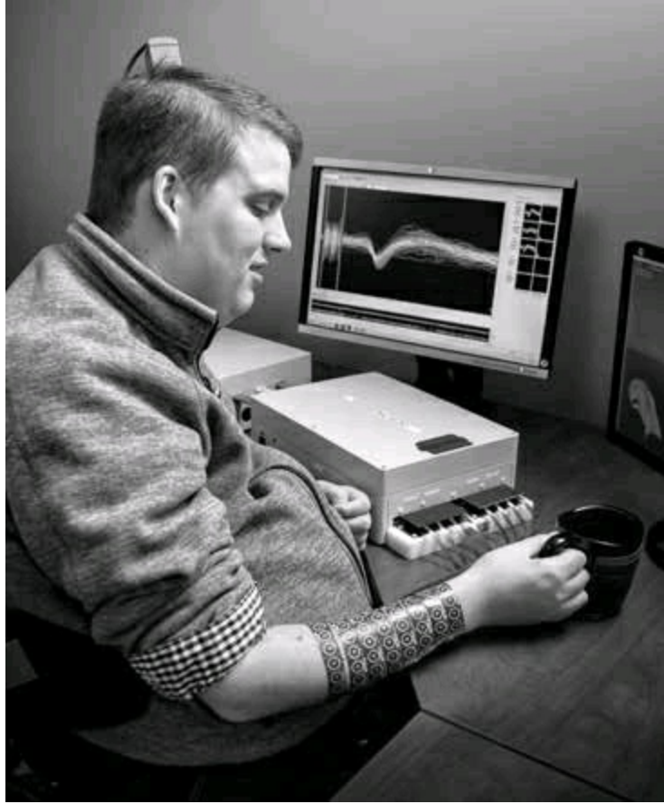
图30 伊恩·伯克哈特借助脑机接口设备，用瘫痪的手抓起杯子。他因脊髓受伤，造成颈部以下瘫痪。植入他运动皮质的电极采集神经活动信号并启动臂带中的电极，刺激适当的肌肉收缩并让手和前臂产生所需的运动
