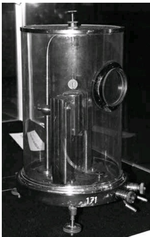
图11 阿道夫·贝克在他的早期实验中使用魏德曼检流计记录了脑电活动。在此期间，出现过各种版本的检流计。这里显示的是达松伐耳检流计。请注意悬挂在扭弦上的那面圆形小镜子，它可以将光束反射到刻度尺上，读数大小与测量到的电信号成比例
