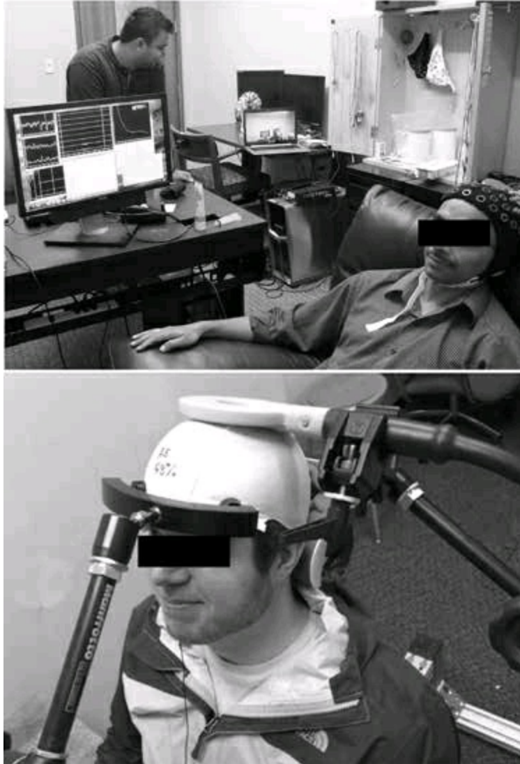
图31 用脑电波进行脑对脑的交流。在上图中，研究人员正在记录一位受试者的脑电图信号。这位受试者正在观看电脑游戏（位于画面之外）。研究人员用采集到的脑电波命令远处的另一个人在视频游戏中进行射击。玩家的脑电波通过互联网传到接收方，并通过经颅磁刺激使接收方的运动皮质产生响应。下图显示，通过笔记本电脑上的Skype软件可以看到脑电波的接收方，经颅磁刺激线圈位于他的头顶
